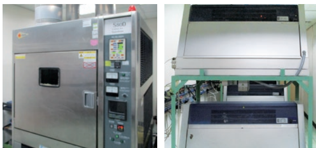
結露循環式カーボンアーク耐候試験機 QUV 耐候試験機
