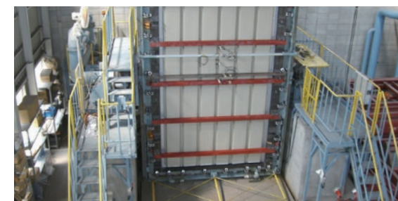
水密・耐風圧試験装置(大阪工場)
