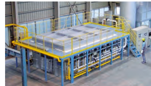
防耐火試験装置（大阪工場）
